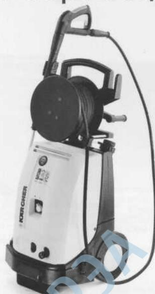
HD 1290 SX отличается большой производительностью - максимально 1200 л/час; особенно надежным исполнением, например, поршнями из нержавеющей стали с керамическими гильзами; интегрированным барабаном для шланга и шлангом высокого давления длиной в 20 м с долгим сроком службы эксплуатации. Колеса оснащаются пневматическими шинами для удобной транспортировки.
