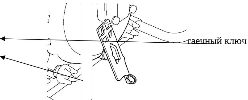
2. При помощи гаечного ключа ослабьте гайки крепления крышки насоса.
